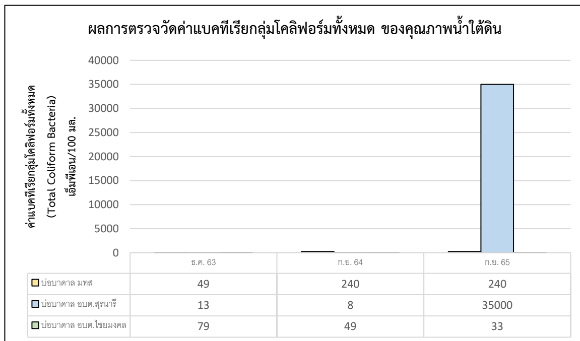
รูปที่ 4.3-7 กราฟเปรียบเทียบค่าแบคทีเรียกลุ่มโคลิฟอร์มทั้งหมด ของคุณภาพน้ำใต้ดิน ระหว่างเดือนธันวาคม พ.ศ. 2563 เดือนกันยายน พ.ศ. 2564 และเดือนกันยายน 2565
